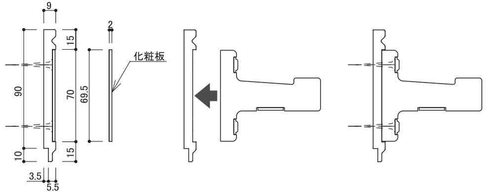
■ 腰壁モールへの取付図(例)
